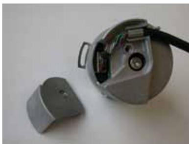
Conector de 12 pinos PCB do fabricante Berg, tipo Minitex Screen, é conectado ao invólucro do encoder através de um cabo de 10 mm
