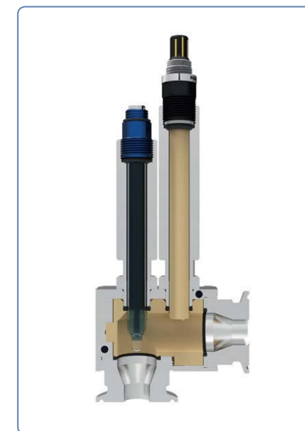
Bild 6: Querschnitt durch die FlowCell 242590
